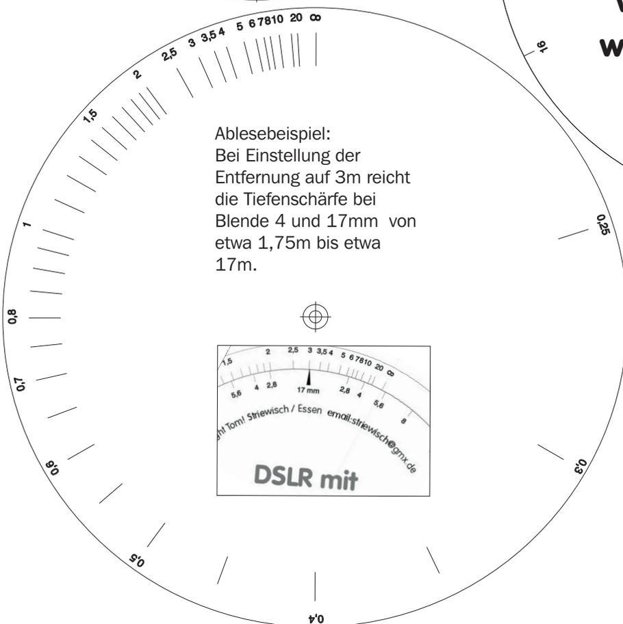
Kleben Sie zwei der Blendenskalen mit den Rückseiten aneinander. Wenn Sie die Scheiben in der Mitte gelocht haben, können Sie sie mit einer Briefklammer mit der Entfernungsskala verbinden. Zum Ablesen stellen Sie die Pfeilmarkierung auf die Entfernung, auf die Sie fokussiert haben. Lesen Sie dann zwischen den beiden Blendenmarkierungen, die zu Ihrer Wunschblende gehören, die Abmessungen der Schärfentiefe ab.
